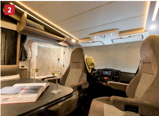
2 Die Hohlwaben des Frontscheibenplissee isolieren den Wohnraum gegen Wärme- und Kälteeinfluss über die Frontscheibe.
