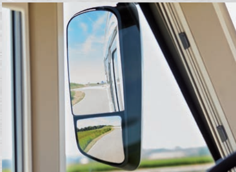
Beste Rundumsicht durch Busrückspiegel mit großem Haupt- und Weitwinkelspiegel
