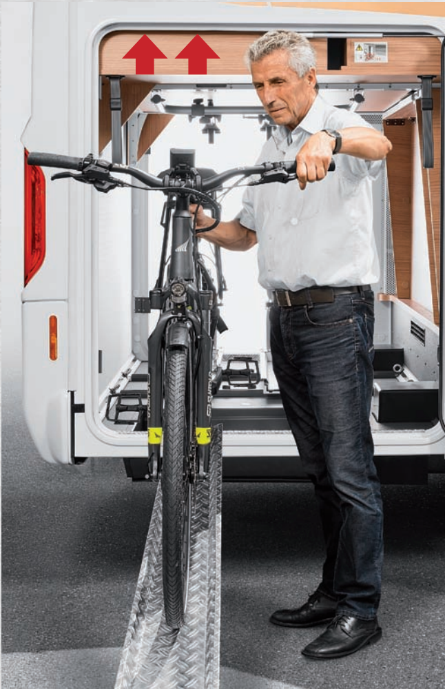
▲ Leichte Beladung eines Pedelecs oder Rollers durch einhängbare Auffahrschiene.
