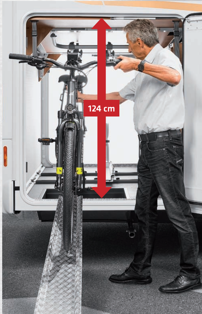
▲ Erweiterung der Beladungshöhe durch einfaches Hochschwenken des innenliegenden Heckbetts mit einer Hand und zusätzliche abgesenkte Bodenmulde (somit Lenkerhöhe bis 124 cm möglich).
